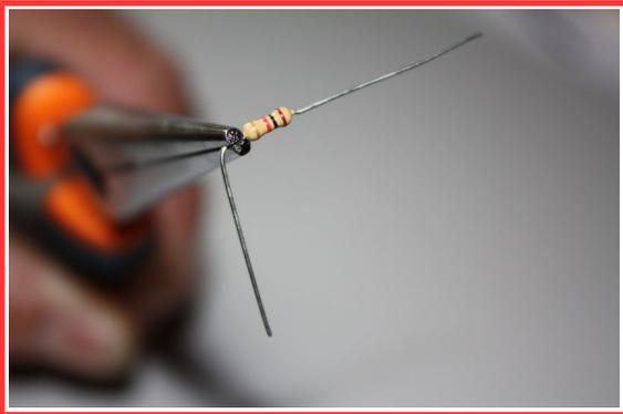
1. Mit Hilfe einer Spitzzange werden die Lötflächen in einem rechten Winkel nach unten gebogen
