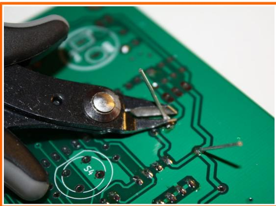
3. Nach dem auflöten des Bauteiles werden die Lötflächen mit einem Seitenschneider entfernt.
