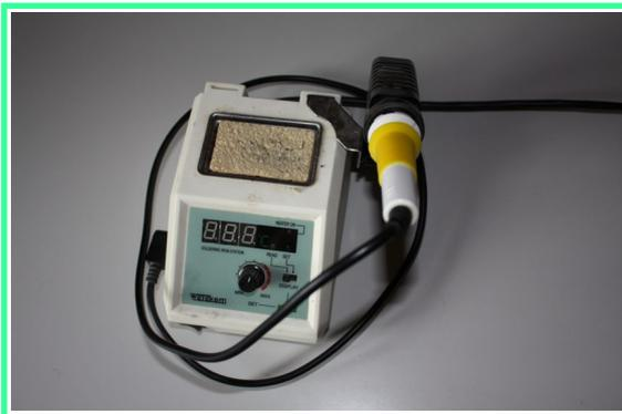
LötKolben (Regelbar) mit Schwamm um
